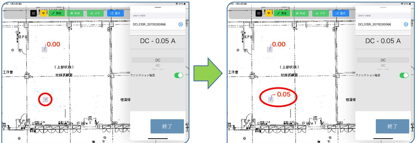
ファンクションが一致していない状態で、測定ポイントをタップすると警告が表示されます。ファンクションを一致させ再度測定を行ってください。
